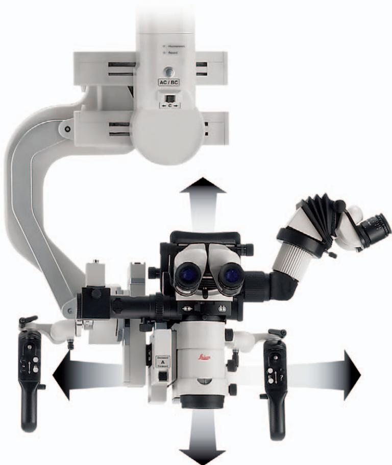
Combinado con un ordenador IGS, la funcionalidad robótica del estativo Leica OH4 permite que el microscopio siga los instrumentos quirúrgicos.
